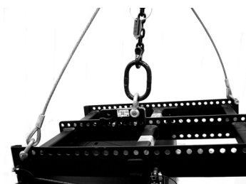
Fig. 29 Zweite unabhängige Sicherung - Typ 2
