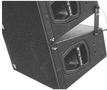
Fig. 17: Wählen des entspr. Öffnungswinkel am Splay Link
